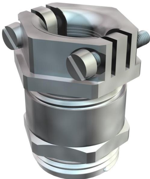
Prensaestopas con descarga de tracción de estribo transversal y de efecto centrado en el tornillo de presión, protección contra el doblado de conductores en movimiento gracias al tornillo de presión extremadamente redondeado.
