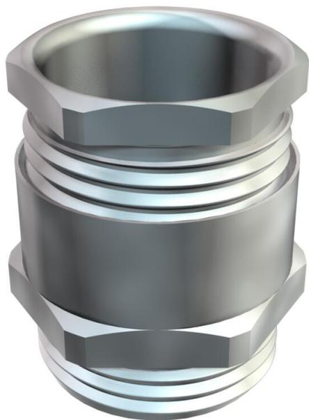
Prensaestopas con racores intermedios hexagonales, forma C4 según DIN 46320, con rosca de conexión métrica según DIN EN 60423 o ISO 68. Aros de presión de acero galvanizado y pasivado transparente. Con empaquetadura de NR/SBR.
