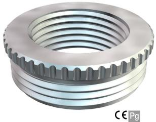
Reducción (parte H) según DIN 46320, con rosca PG según DIN 40430, para pasar de un orificio con rosca PG a un prensaestopas de pequeño tamaño. \* Precios según anotación DEL.
