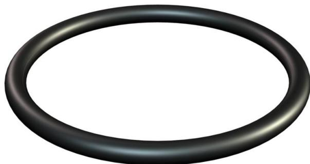
Juntas tóricas, adecuadas como anillos de sellado para roscas de conexión para todos los prensaestopas de plástico y latón con rosca de conexión PG según EN 60423 o ISO 68. Las juntas tóricas se pueden montar de manera que no se pierdan.
