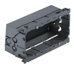
Caja portamecanismos de fijación frontal para el montaje de 2 mecanismos simples o una toma de tierra con enchufe múltiple. La base se puede quitar o abatir simplificando el proceso de conexión del cableado. Incluye perforaciones para cables de hasta 14 mm. Modelo sin halógenos. Riel de fijación vertical 60 mm.
