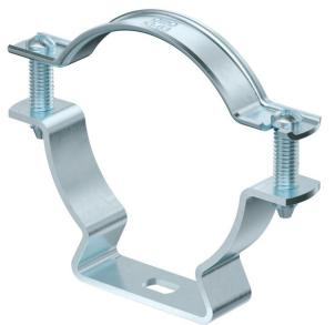
Abrazadera para el montaje de tubos y cables en la pared, el techo y el suelo. Con tapa autoblocante. Fijación a través de agujero alargado. Testado y aprobado para el mantenimiento de funciones según DIN 4102 Parte 12, clases de mantenimiento de funciones E 30 a E 90.
