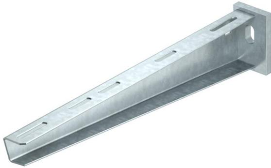
Escuadra de pared/perfil de cargas medias con cabeza para perfil soldada. Fijación de la escuadra en el perfil en U a partir de un ancho de 400 mm usando tornillo de cabeza hexagonal a ambos lados del soporte. Utilice para ello la pieza distanciadora adecuada.
