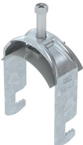
Abrazadera sobre perfil con base F, mediacaña de plástico de polipropileno. Para el montaje vertical y horizontal de 1 cable individual en perfiles planos. Con tornillo de 1 paso en la mediacaña, cabeza de tornillo hexagonal universal SW10, con ranura y ranura en cruz. Adecuado para montaje en zonas interiores y exteriores. Se recomienda el uso de una contra-caña.
