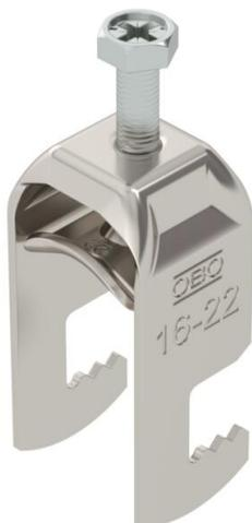
Abrazadera sobre perfil con base F, mediacaña metálica con bordes redondeados para proteger los cables. Para el montaje vertical y horizontal de 1 cable individual en perfiles planos. Con tornillo de 1 paso en la mediacaña, cabeza de tornillo hexagonal universal SW10, con ranura y ranura en cruz. Adecuado para montaje en zonas interiores y exteriores. Se recomienda el uso de una contra-caña.
