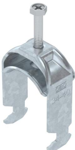
Abrazadera sobre perfil con base con cabeza de martillo, mediacaña metálica con bordes redondeados para proteger los cables. Para el montaje vertical y horizontal de 1 cable individual en perfil tipo C. Para ancho de ranura de 16 - 17 mm. Con tornillo de 1 paso en la mediacaña, cabeza de tornillo hexagonal universal SW10, con ranura y ranura en cruz. Adecuado para montaje en zonas interiores y exteriores. La contraña se debe pedir por separado.
