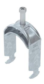
Abrazadera sobre perfil con base con cabeza de martillo, mediacaña metálica con bordes redondeados para proteger los cables. Para el montaje vertical y horizontal de 1 cable individual en perfil tipo C. Para ancho de ranura de 16 - 17 mm. Con tornillo de 1 paso en la mediacaña, cabeza de tornillo hexagonal universal SW10, con ranura y ranura en cruz. Adecuado para montaje en zonas interiores y exteriores. La contracaña se debe pedir por separado.
