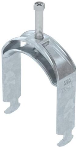
Abrazadera sobre perfil con base con cabeza de martillo, mediacaña metálica con bordes redondeados para proteger los cables. Para el montaje vertical y horizontal de 1 cable individual en perfil tipo C. Para ancho de ranura de 16 - 17 mm. Con tornillo de 1 paso en la mediacaña, cabeza de tornillo hexagonal universal SW10, con ranura y ranura en cruz. Adecuado para montaje en zonas interiores y exteriores. La contraña se debe pedir por separado.
