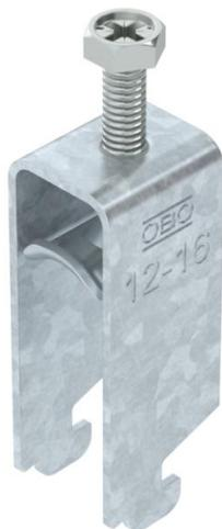
Abrazadera sobre perfil con base N, mediacaña metálica con bordes redondeados para proteger los cables. Para el montaje vertical y horizontal de 2 cables individuales en perfil tipo C. Para ancho de ranura de 11 - 12 mm. Con tornillo de 1 paso en la mediacaña, cabeza de tornillo hexagonal universal SW10, con ranura y ranura en cruz. Adecuado para montaje en zonas interiores y exteriores. Es conveniente separar varios cables mediante cañas dobles. Se recomienda el uso de una contra-caña.
