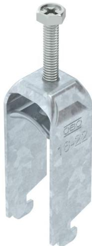
Abrazadera sobre perfil con base N, mediacaña metálica con bordes redondeados para proteger los cables. Para el montaje vertical y horizontal de 2 cables individuales en perfil tipo C. Para ancho de ranura de 11 - 12 mm. Con tornillo de 1 paso en la mediacaña, cabeza de tornillo hexagonal universal SW10, con ranura y ranura en cruz. Adecuado para montaje en zonas interiores y exteriores. Es conveniente separar varios cables mediante cañas dobles. Se recomienda el uso de una contra-caña.
