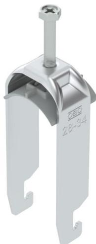
Abrazadera sobre perfil con base U, mediacaña de plástico de polipropileno. Para el montaje vertical y horizontal de 2 cables individuales en perfil tipo C. Para ancho de ranura de 18 - 22 mm. Con tornillo de 1 paso en la mediacaña, cabeza de tornillo hexagonal universal SW10, con ranura y ranura en cruz. Adecuado para montaje en zonas interiores y exteriores. Es conveniente separar varios cables mediante cañas dobles. Se recomienda el uso de una contra-caña.
