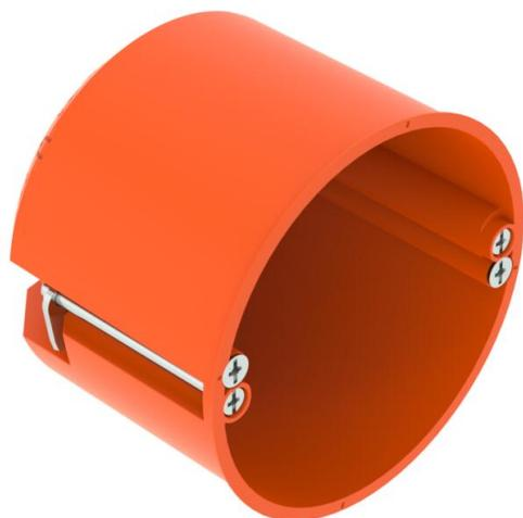
Caja portamecanismos para paredes huecas CEE/PERILEX para el uso en paredes huecas con una profundidad de montaje de mínimo 61 mm y un grosor de placa de 5 - 40 mm.
