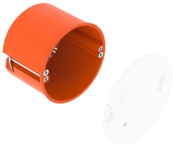
Caja portamecanismos para paredes huecas CEE/PERILEX con tapa, para el uso en paredes huecas con una profundidad de montaje de mínimo 61 mm y un grosor de placa de 5 - 40 mm.
