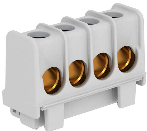
Bornes de latón, tornillos de acero, electrolgalvanizados y con pasivado transparente, sección nominal 16 ÷ 35 mm<sup>2</sup>, tensión nominal 400 V, 1 polo, con bloques de terminales, conductor máx. que se puede conectar en cada borne máx. 4x35mm<sup>2</sup>, 4x25mm<sup>2</sup>, 8x16mm<sup>2</sup> o 12x10mm<sup>2</sup>.
