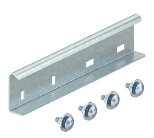
Conector de expansión para compensación de elongación por causas térmicas. Los pares de apriete de los tornillos autobloqueantes en el lado del rodamiento de flexible es de 5 Nm.
