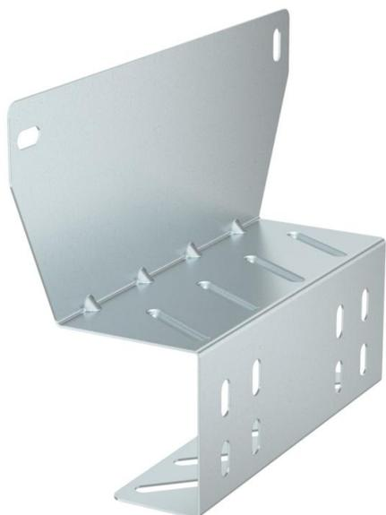
Placa de montaje para la fijación de cajas de derivación de la serie T FireBox (con fijación exterior) en bandejas portacables y de escalera con 60 mm de ala. La forma constructiva angular de chapa de acero reforzada con molduras permite el montaje seguro de los cables de mantenimiento de función, sin que sea necesario doblar el cable sobre la barra lateral.
