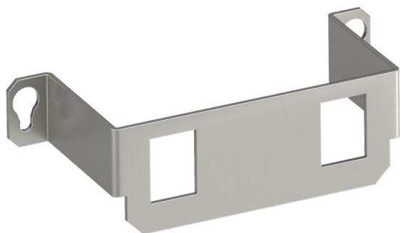
Soporte de montaje para alojar dos módulos de conexión de datos de los tipos siguientes: AMP TYCO: 110Connect estándar, serie SL 110Connect y Toolless, AMP-Twist; Brand-Rex: sin apantallar; GG45; TKM RJ MOD; Nexans: LANmark con clip adaptador; Siemon CAT6; 3M K6 y K10.
