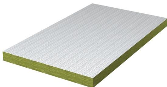
Con pintura intumescente PYROCOAT® ASX, placa de fibra de mineral con revestimiento previo como base para el sistema de aislamiento blando PYROPLATE® Fibre. Placa de 60 mm para aislamiento conforme a la homologación europea. Uso en interiores.
