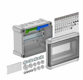
Distribuidor pequeño con regleta de bornes para el montaje empotrado, para subdistribución de corriente en interiores y exteriores, según IEC 439-3. Con carril en U premontado de 35 mm. Tipo de protección IP66 y grado de protección IK06. Tapa transparente para atornillar, con sección.
