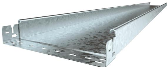
Bandeja portacables sin perforar con sistema de fijación rápida integrado. La longitud útil de la bandeja portacables es 3.000 mm. La conexión equipotencial continua queda asegurada sin componentes adicionales.
