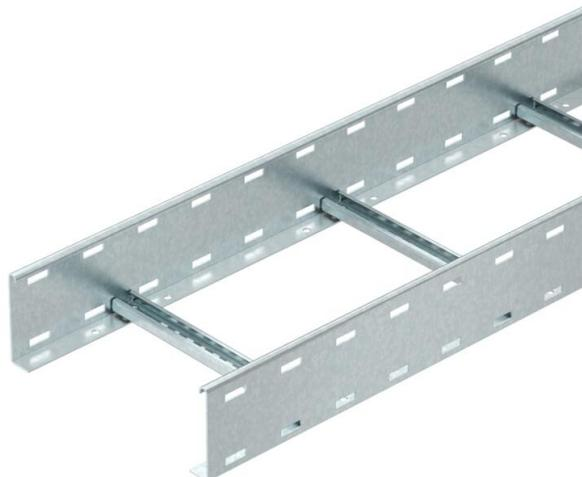
Bandeja de escalera con ala de 110 mm con peldaños de perfil C30 soldados, abiertos hacia arriba. Barra lateral enrollada como refuerzo y como protección de bordes. La fijación en la escuadra se realiza con bridas de fijación LKS 40. La medida de la ranura del peldaño es de 16,5 mm; la abrazadera de media caña sobre perfil adecuada es 2056. Aislamiento magnético sin tapa 10 dB, con tapa 15 dB.
