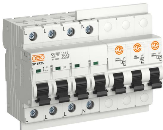
Protector contra sobretensiones permanentes. Para líneas trifásicas. Alimentación a 240/400VAC. Con IGA de 10kA de poder de corte y curva de disparo Clase C.
