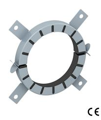
Collarín para tubos inflamables. En caso de incendio, las capas intumescentes insertadas en la carcasa de chapa de acero cierran con una alta presión de expansión los tubos termoplásticos que se estén quemando. Uso en interiores. Fijación con tacos o varillas roscadas M6 hasta un tamaño de 75, o M8 para tamaños superiores.
