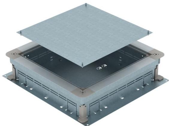
Caja de derivación y de registro bajo suelo para sistemas de canalización bajo pavimento con paredes laterales de chapa de acero. Para el montaje de unidades en tapa de montaje (pedir por separado). Se puede nivelar de forma continua a la altura de pavimento (es posible una nivelación rápida) y el pavimento puede montarse a ras del borde de extracción. Con posibilidad de desacoplamiento acústico tras el montaje de pavimento y de aplicación de cargas pesadas con accesorios adicionales.
