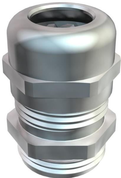
Prensaestopas tipo tuerca de capuchón con amplia zona estanca, así como con descarga de tracción y protección contra la torsión para situaciones donde se exija una alta estanquidad con rosca de conexión PG según DIN 40430. Empaquetadura de caucho cloropreno/nitrílico, con anillo de sellado premontado en la rosca de conexión.
