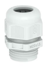
Prensaestopas con rosca de conexión métrica de tipo con tuerca de capuchón, para cajas de derivación, carcasa, armarios de distribución en sector privado e industrial. Con descarga de tracción y labio de sellado integrado , probado según DIN EN 62444. Clase de protección IP68. Se puede utilizar entre -20 °C y +65 °C. Incluida contratuerca.
