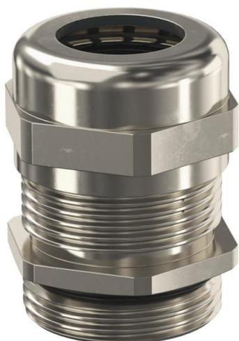
Prensaestopas robusto con rosca de conexión métrica según IEC 423 de tipo con tuerca de capuchón para situaciones donde se exige una elevada estanqueidad. Descarga de tracción, protección contra la torsión y estanqueidad a lo largo de toda la zona de apriete. Empaquetadura de neopreno. Bloque de terminales de poliamida. Con junta de sellado premontada en rosca métrica, probado VDE según DIN EN 50262, grado de protección IP68 a 5 bar/1 h, rango de temperatura entre -20 y +100 °C.
