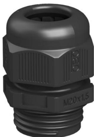
Prensaestopas con rosca de conexión métrica de tipo con tuerca de capuchón, para cajas de derivación, carcasa, cajas de distribución en sector privado e industrial. Con descarga de tracción y labio de sellado integrado, probado según DIN EN 62444. Clase de protección IP68. Se puede utilizar entre -20 °C y +65 °C.
