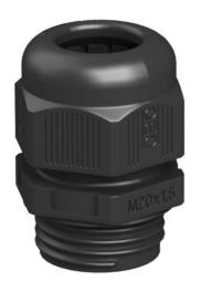
Prensaestopas con rosca de conexión métrica de tipo con tuerca de capuchón, para cajas de derivación, carcasa, cajas de distribución en sector privado e industrial. Con descarga de tracción y labio de sellado integrado , probado según DIN EN 62444. Clase de protección IP68. Se puede utilizar entre -20 °C y
