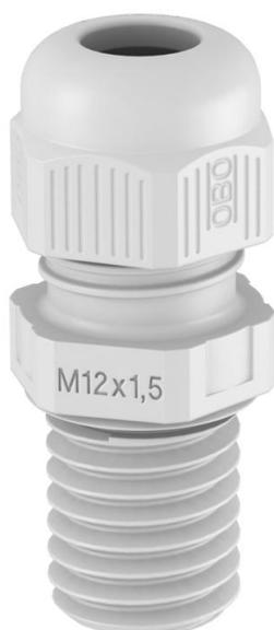
Prensaestopas con rosca de conexión métrica de tipo con tuerca de capuchón, para cajas de derivación, carcasa, armarios de distribución en sector privado e industrial. Con descarga de tracción y labio de sellado integrado, probado según DIN EN 62444. Clase de protección IP68. Se puede utilizar entre -20 °C y +65 °C.
