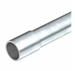
Tubo para instalaciones eléctricas según EN 61386-1, con extremos roscados según DIN EN 60423, para la protección mecánica de cables y conductores. Con pared interior sin rebabas. Clase de protección contra la corrosión 2 (media). Por cada tubo ya se ha enroscado un manguito de unión.
