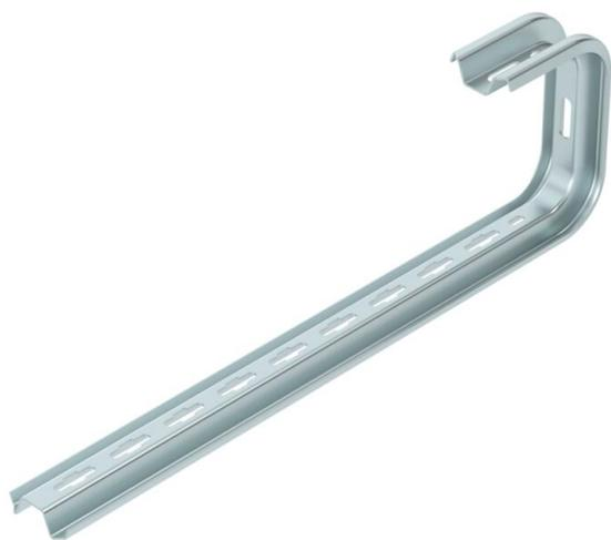
Escuadra de pared/techo TP para la fijación universal de construcciones. Importante. Si el soporte se fija directamente a la pared o al techo, por razones de estabilidad, se instala siempre una pieza distanciadora DS 4. Altura lateral máx. del sistemas de bandejas portacables de 60 mm.
